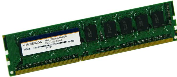
Figure 4: Esempio di memoria RAM moderna: le parti nere sono le capsule plastiche contenenti i circuiti integrati, la parte verde è un supporto meccanico che integra i contatti per poterli collegare al bus
